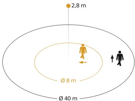
Possibile altezza di montaggio: 2,50 m - 4,00 m
